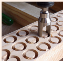
②回転中は強く押し付けない。押し付け過ぎるとキレイな木栓ができません。
