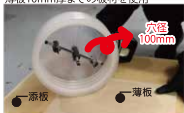
①充電ドリル用自在錐に充電自在錐用ダストカバーをセットします
