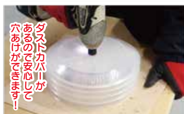
②加工材をしっかりと押さえながら穴径 100mm をあけます
