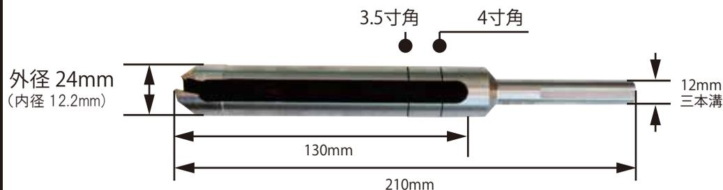
■材質：普通鋼 ■適用機種：ドリルドライバ 14.4V 以上・電気ドリル ■適正回転数：1,500 回転 / 分以下
