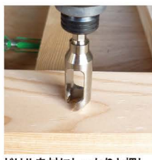
ドリルを材にしっかりと押し付けてから回転させる。
