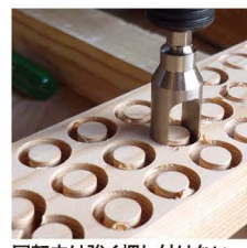
回転中は強く押し付けない。押し付け過ぎるとキレイな木栓ができません。
