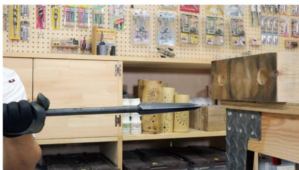
拡張ドリルで中心のずれを拡げて修正する
