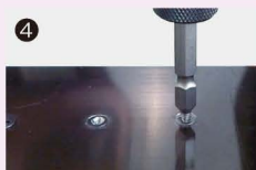
下穴に専用ビットを差し込み電動工具を逆回転する。
