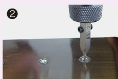
つぶれたネジ頭に下穴ドリルで穴を深めにあける。
