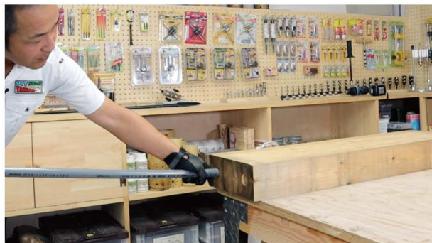
金物を通すが通らない！ 中心部分で穴がズれていることが原因
