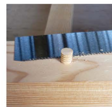
突起部を鋸で切り取る。
