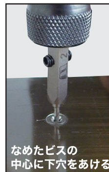
下穴に専用ビットを 差し込み逆回転で抜く
