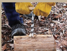
⑥板目側から横穴をあける内部の燃焼室を作るため
