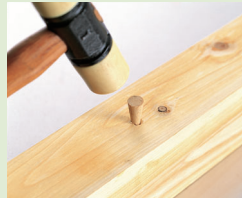
③ テーパー錐であけた節穴に接着剤を塗布した木栓を打ち込む。突起した部分を切り取りカンナで仕上げる。
