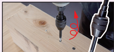
④インパクトドライバを逆回転し折れたビスを抜き取る。
