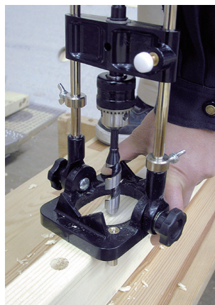
ロックピンを利用した 角材へのセンター穴・ダボ穴
